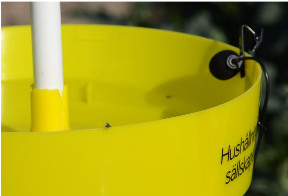
Figur A4. Uppställning för inspelning av flygljud i fält. Mikrofonen monterades på kanten av en gulskål, som lockar många typer av insekter. På bilden syns en vivel på väg att flyga därifrån.
