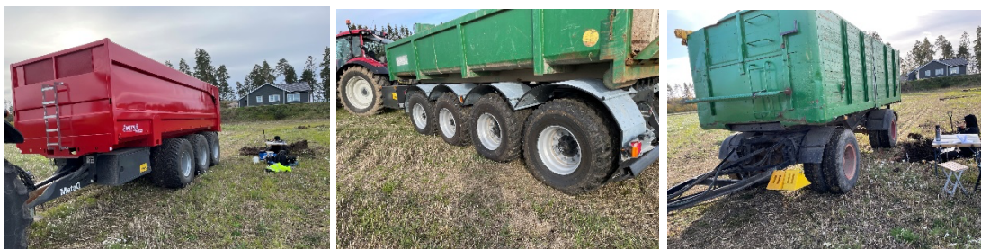
Figur 2. Hi-tech vagnarna MetaQ75 med 3 axlar (hullast 5000 kg), Metaflex4 med fyra axlar (hullast 3750 kg) och konventionell vagn med två axlar (hullast 3750 kg) användes i testet.
