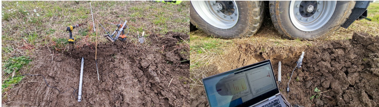
Figur 1. Mätning vid överfart med hi-tech vagn. Hål borras horisontellt i gropväggen och sensorer skjuts in så de placeras mitt under däck. Vagnen körs parallellt med en grop under mätningen och data loggas.
