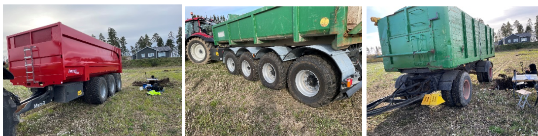
Figur 2. Hi-tech vagnarna MetaQ75 med 3 axlar, Metaflex4 med fyra axlar och konventionell vagn med två axlar användes i testet.
